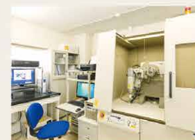
X線回折装置 薬品・セラミックス・金属などの工業材料の結晶構造を調べる装置です。
