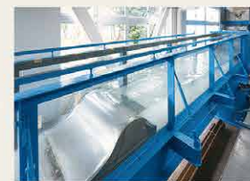
水理基礎実験装置 洪水時の河川や水路の基礎的な流れの特性を理解することができます。
