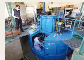
動的遠心力模型実験装置 模型地盤に遠心加速度を作用させ、地震力も作用させる装置です。
