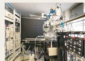
電子ビーム蒸着装置 電子ビーム照射で元素を加熱蒸発させて薄膜を形成する装置です。
