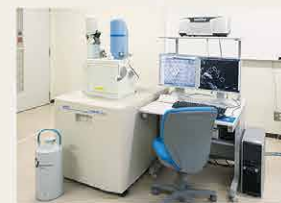
走査型電子顕微鏡(SEM) 試料表面を何百倍にも拡大して観察できる装置。元素分析もできます。
